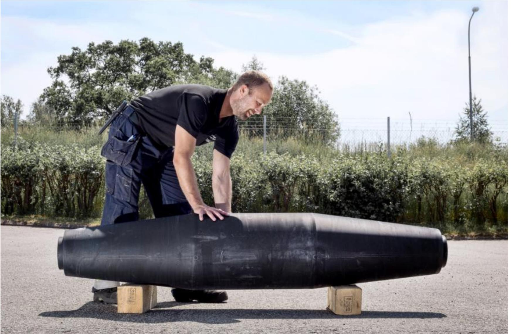
**Muffen zur Verbindung der Erdkabelteile**
